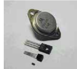
Transistorer tillverkas av halvledande ämnen. Transistorn förstärker en signal eller öppnar och stänger en elektrisk krets.
