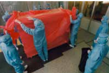
Processutrustning har anlänt till Ericsson Microelectronics nya halvledarfabrik. Utrustningen tvättas noggrant i olika steg av renrumsklädd personal innan den lyfts in i fabriken.
